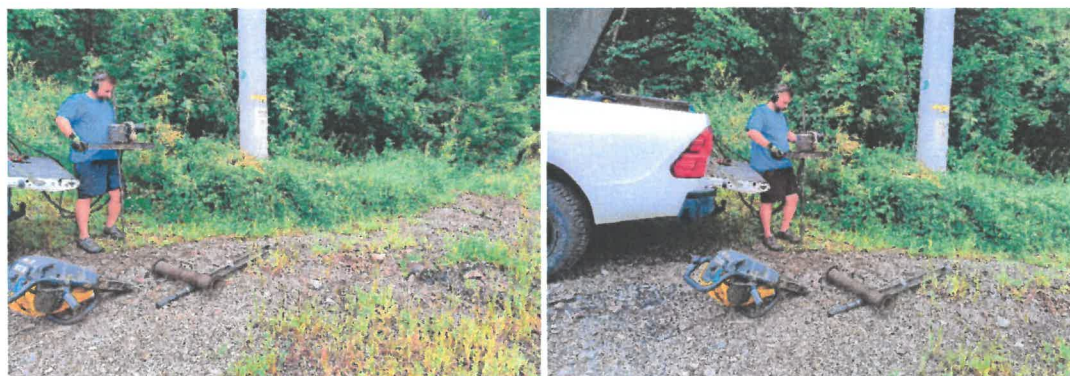
Figura 14. Realizare penetrare dinamică medie PDM01
